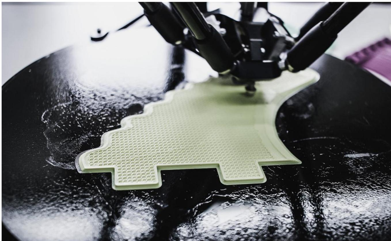
Для 3D-печати в принтере должен быть установлен файл системы автоматизированного проектирования (CAD file, computer-aided design file) – технический чертеж, считываемый принтером и содержащий проект предмета для печати.
